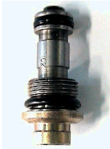
Figura 3.6: Inchamento e deformação de anel O´ring fabricado de NBR (Boldo; Wahnfried; Massagardi, 2001).
