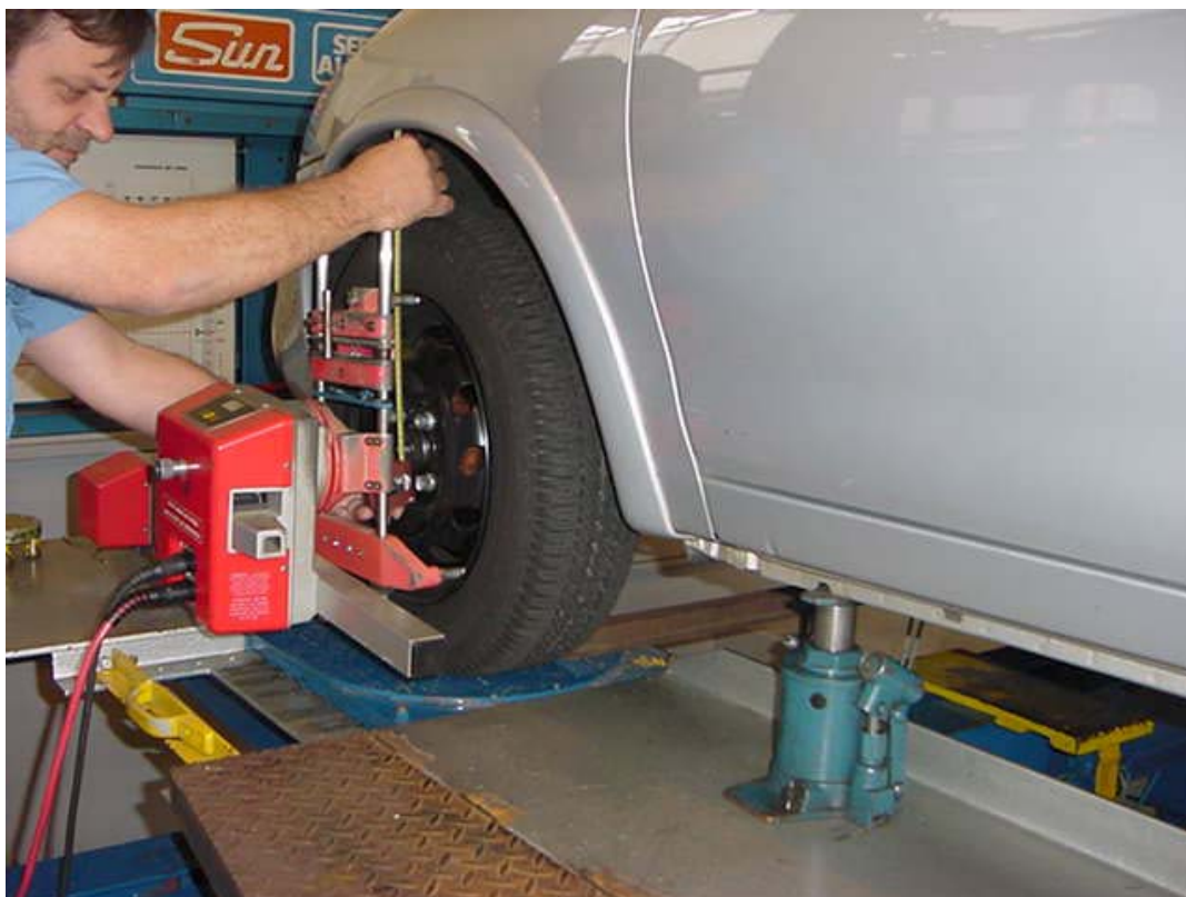
Figura 32 – Macaco hidráulico para erguer a suspensão dianteira
