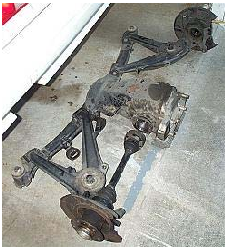
Figura 15 – Modelo Semi-Trailing Arm BMW (Barras Parciais)
