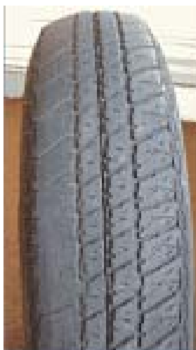
Figura 21 - Desgaste da banda de rodagem devido ao desalinhamento das rodas
