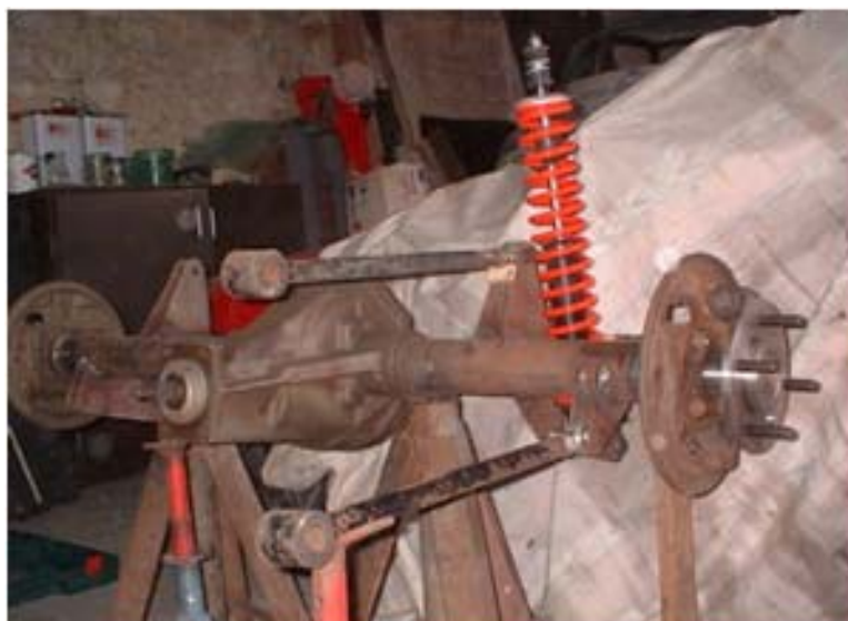
Figura 18 – Modelo Four Link (Quatro barras)
