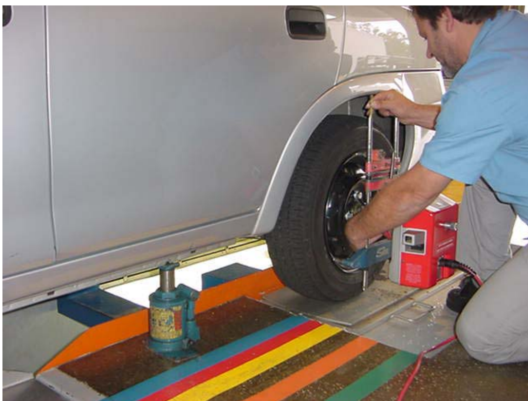
Figura 33 - Macaco hidráulico para erguer a suspensão traseira
