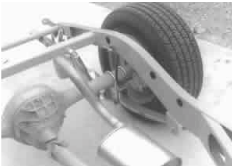
Figura 17 - Modelo Hotchkiss (Eixo Sólido)
