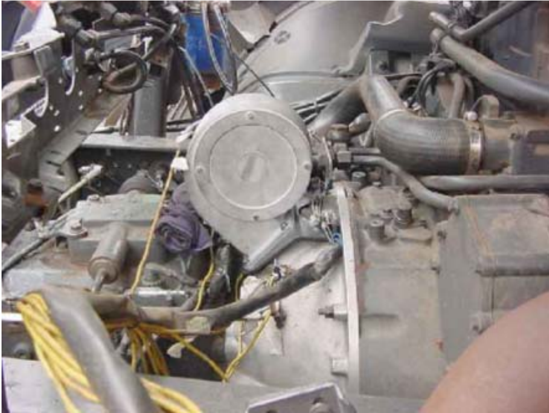
Figura 44 – Instalação de ventilação forçada no ambiente da embreagem
