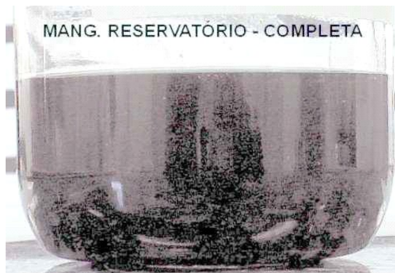
Figura 21 – Fluido escurecido após teste de compatibilidade química com mangueira do reservatório de fluido de embreagem
