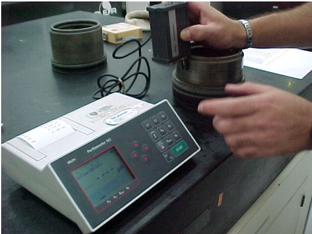
Figura 56 – Procedimento experimental para medição de rugosidade em êmbolos
