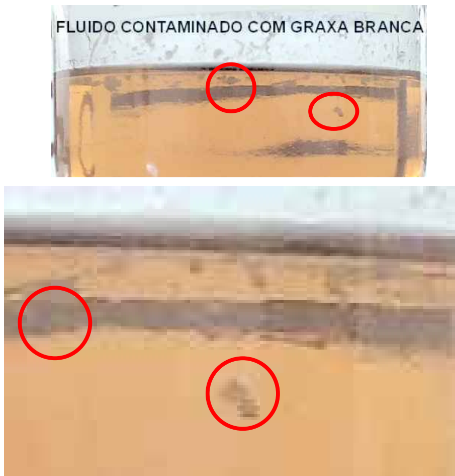
Figura 34 – Bolhas de graxa não diluídas no fluido DOT 4
