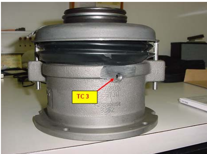
Figura 39 – Ponto para instalação de termopar para medição de temperatura no interior do cilindro escravo concêntrico.
