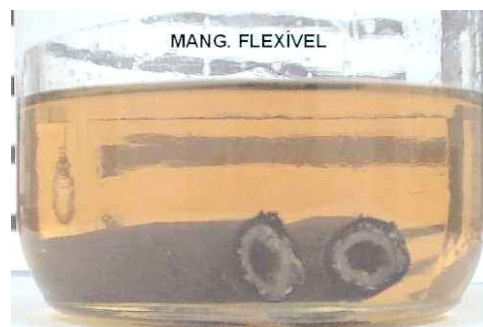
Figura 24 – Aspecto do fluido após teste de compatibilidade química com camada de borracha interna da mangueira do reservatório
