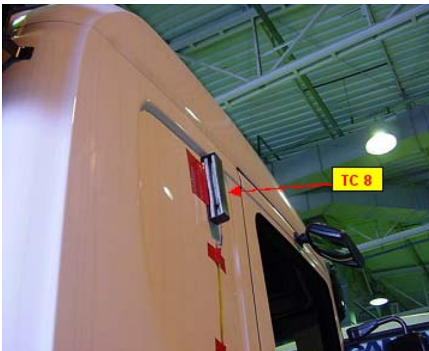
Figura 41 – Ponto para instalação de termopar para medição de temperatura ambiente
