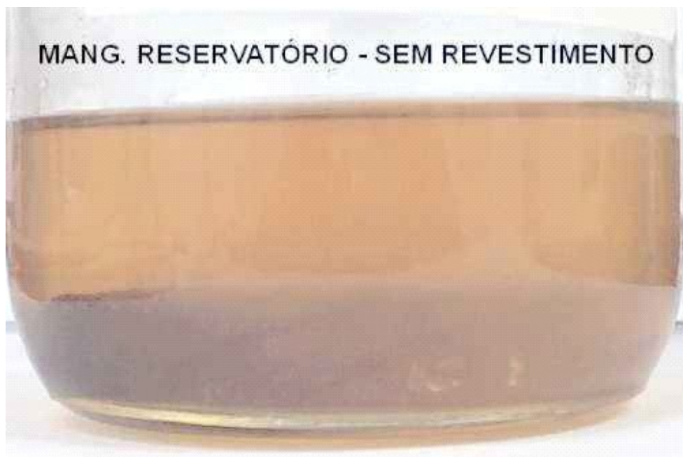
Figura 22 – Aspecto do fluido após teste de compatibilidade química com camada de borracha interna da mangueira do reservatório
