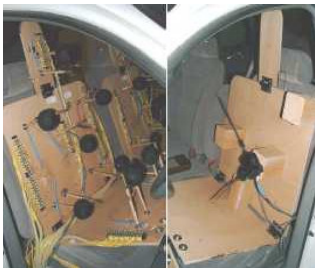
Figura 2-3 Sitzkman dentro do veículo (esquerda) e versão simplificada para medições de velocidade de ar (direita) (Hosni et al , 2003c)
