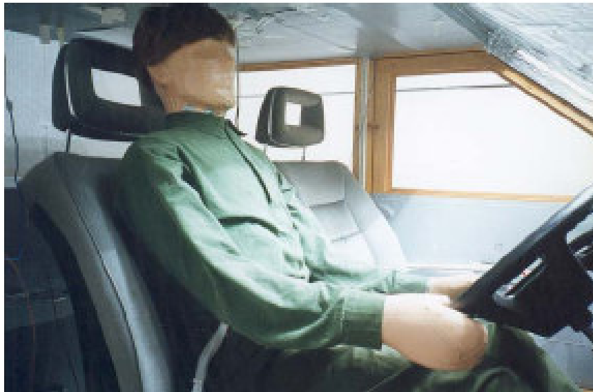
Figura 2-4 Manequim térmico instalado em uma cabina para testes de aquecimento (Nilsson, 2004)
