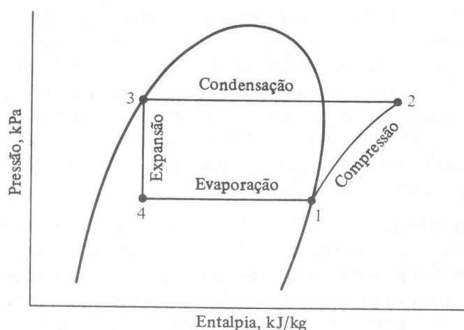
Figura 4-3 Diagrama p-h de um ciclo padrão de refrigeração (Stoecker, 1985)
