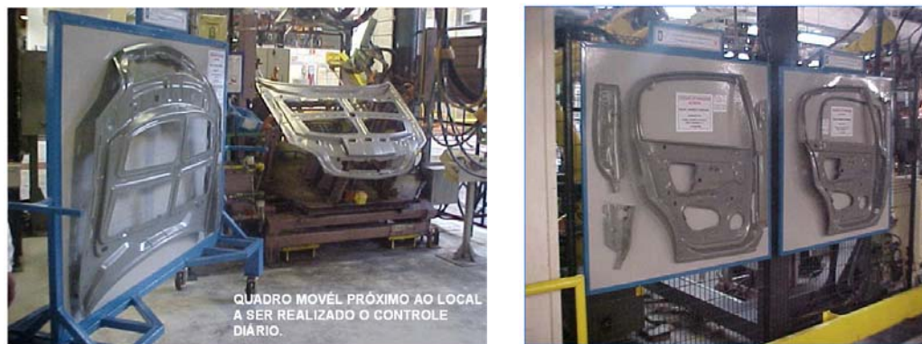
Figura 48 – Quadro de peças padrão e dispositivo de junção da tampa do compartimento do motor e porta traseira.
