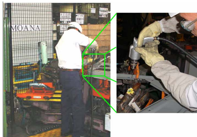
Figura 43 – Realização dos furos e preparação de peças padrão.
