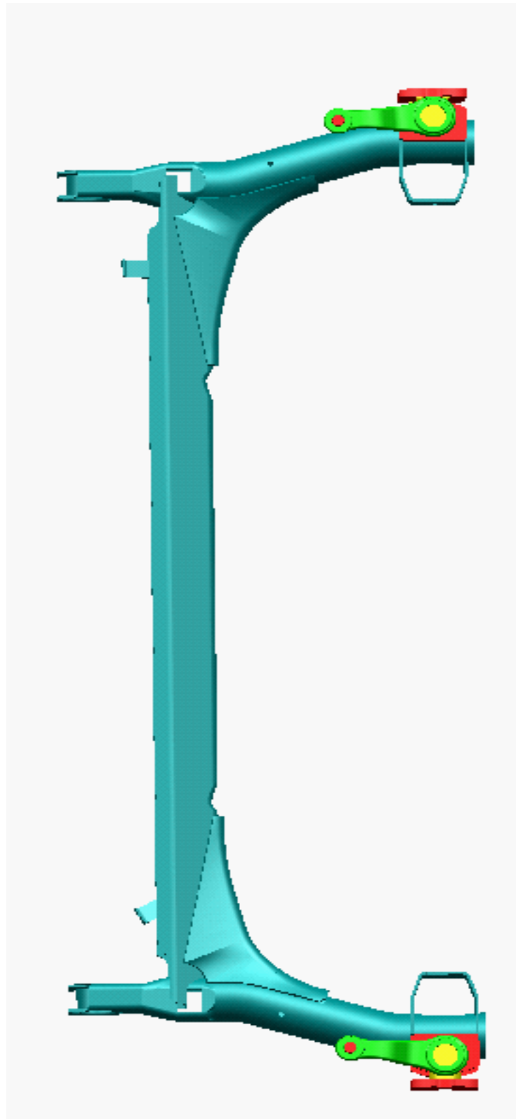
Desenho 3.7 – Vista inferior (por baixo) da manga soldada no eixo
