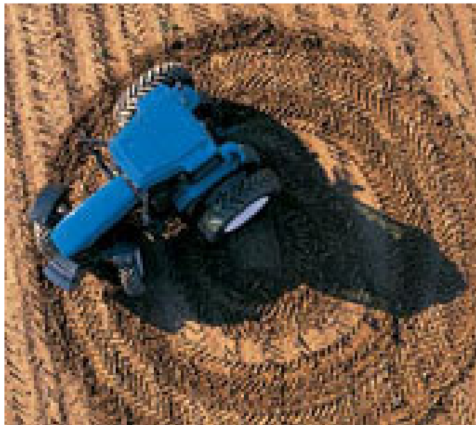
Figura 2.1.2.2- Modelo da CNH produzido com eixo sobre-esterçante.
