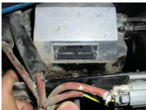
Figura 11.1 – Corpo de válvulas para gerenciamento da suspensão.
