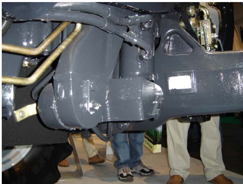
Figura 2.1.2.5 – Eixo rígido, suspensão com cilindros hidráulicos.
