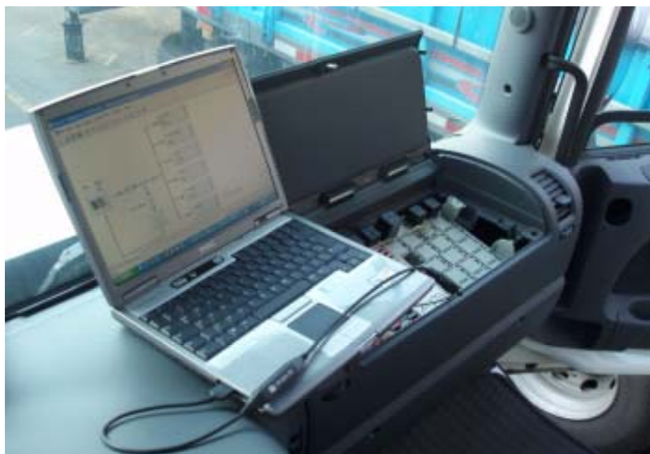
Figura 39 - Equipamentos utilizados nas medições em um veículo Scania.
