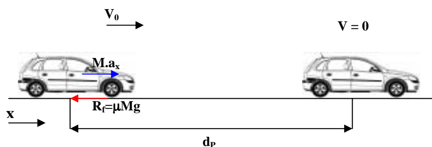
Fig. 5.4 – Veículo em frenagem: Diagrama simplificado de forças
