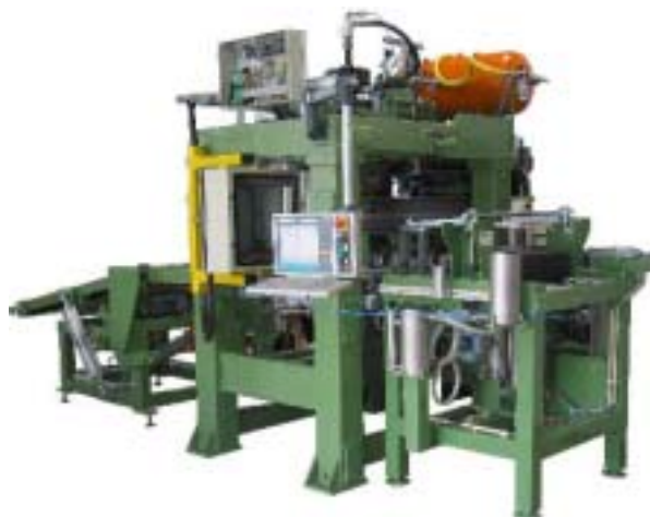
Fig. 4.6 – Máquina de teste da uniformidade [51]
