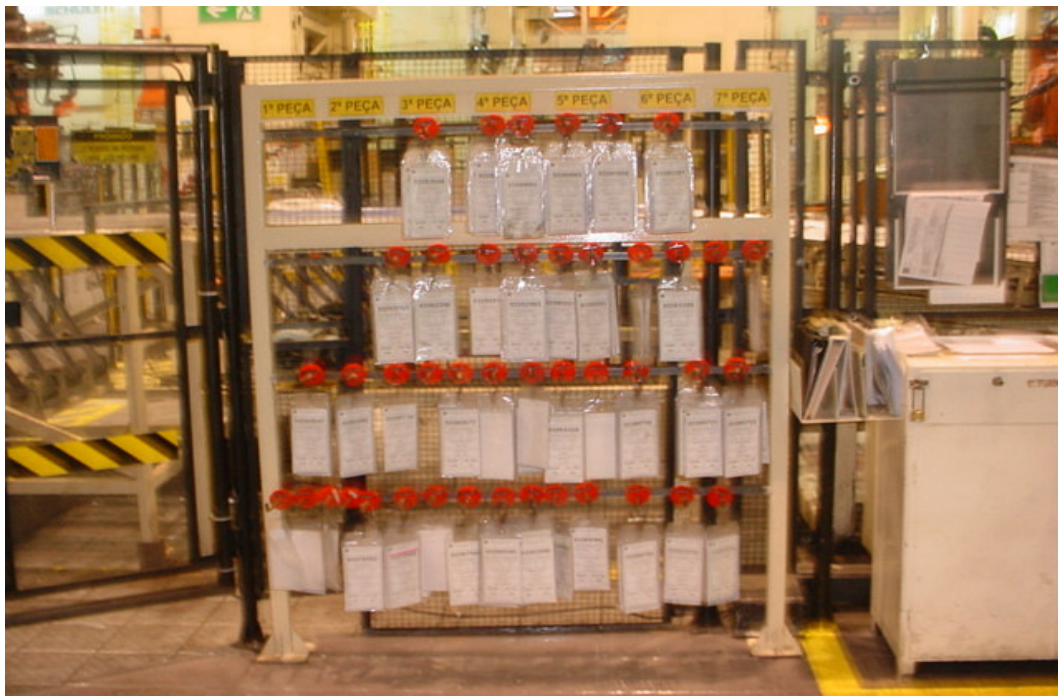
Figura 18 - Painel de controle da produção seqüenciada, produção pré-determinada para todos os dias do mês.
