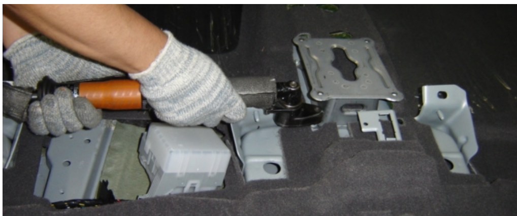
Fig. 7.13: Operador fixando o adaptador da alavanca de câmbio
