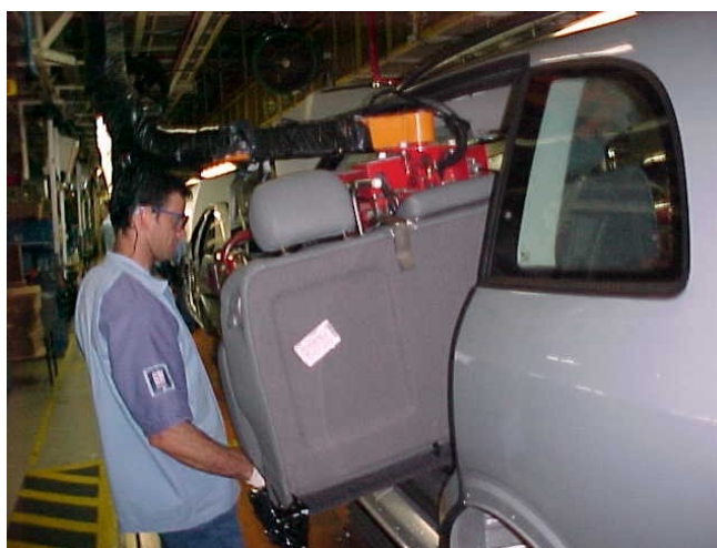
Fig. 7.19: Operador posicionando o banco traseiro dentro do veículo
