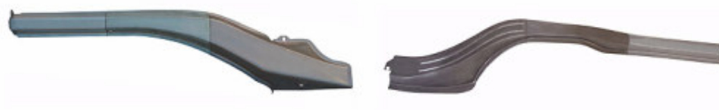
Figura 18 - Longarinas com tailored blank de 3 espessuras.
