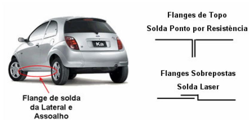
Figura 30 - Junção da Lateral com Assoalho.
