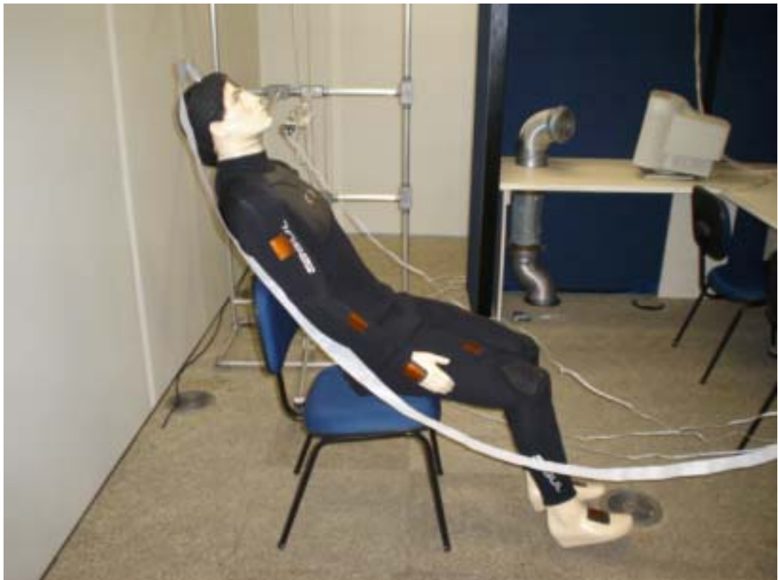
Figura 5.5 Posicionamento do manequim na câmara para calibração
