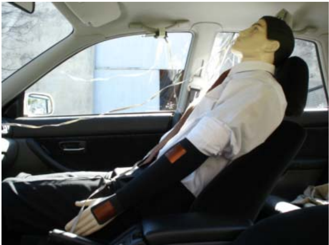
Figura 5.6 Manequim posicionado para ensaio com roupa 0,6 clo (verão)
