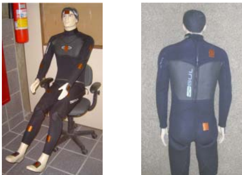
Figura 5.1 Manequim com sensores aquecidos utilizado nos ensaios.
