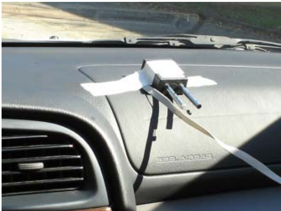
Figura 5.11 Posição do anemômetro e termômetro na altura do painel
