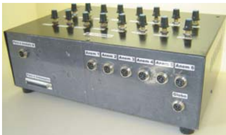
Figura 5.2 Módulo B de controle de potência e conexão de sensores para levantamento de dados ambientais.
