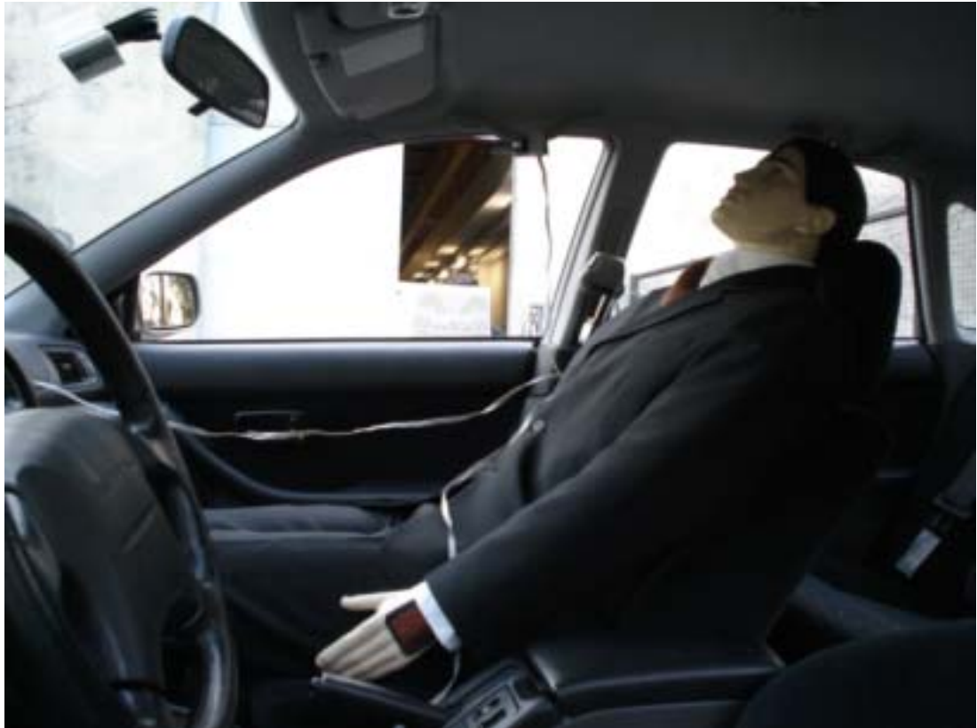
Figura 5.7 Manequim posicionado para ensaio com roupa 1,0 clo.
