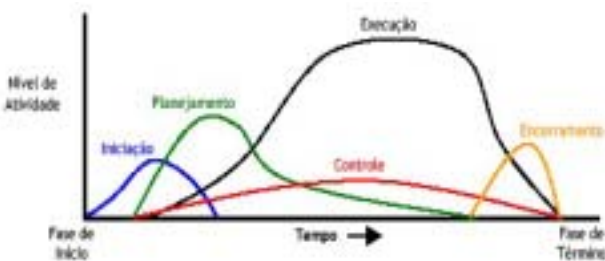
Figura 5 – Sobreposição de grupos de processos em uma fase do projeto (PMBOK GUIDE).
