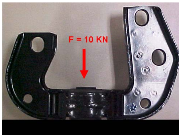
Figura 1.7 – Posição de inserção da bucha hidráulica no suporte
