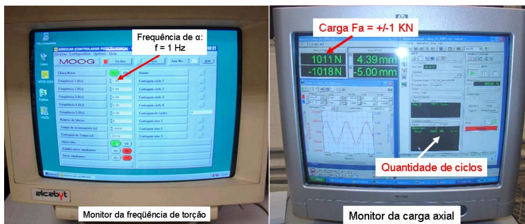
Figura 4.13 – Monitores do teste de fadiga
