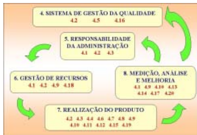
Fig. 2 - Redistribuição dos 20 elementos da ISO 9001:1994 nas 5 seções da ISO 9001:2000 (Cicco, 2002)
