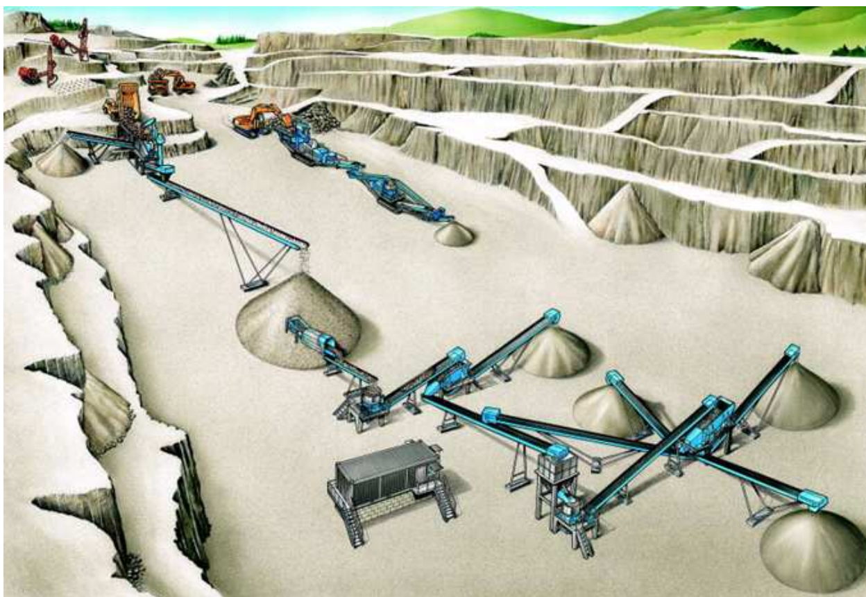
Figura 2.3 – Ilustração de uma instalação de britagem (Fonte: Manual de treinamento da empresa em estudo)
