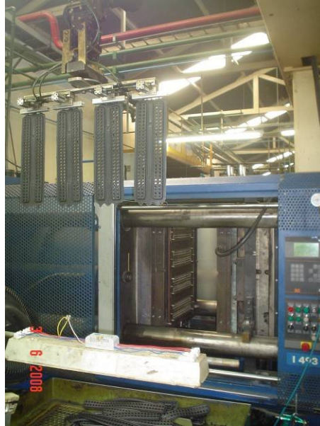
Figura 3.5. Máquina e molde de injeção da junta, durante a extração por robô
