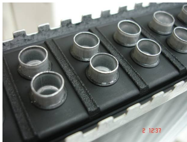
Figura 4.5. Conjunto junta-coletor-colméia após a operação de transferência, com os tubos expandidos e as extremidades rebordeadas
