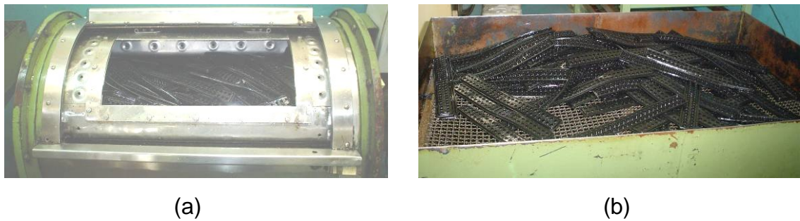
Figura 3.7. Lubrificação: (a) tambor de aplicação da solução de silicone e (b) componentes sobre a grelha para remoção de excesso
