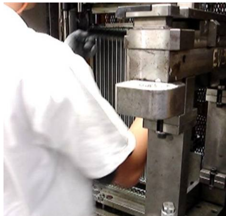
Figura 4.6. Operador inserindo o conjunto junta-coletor ao berço superior
