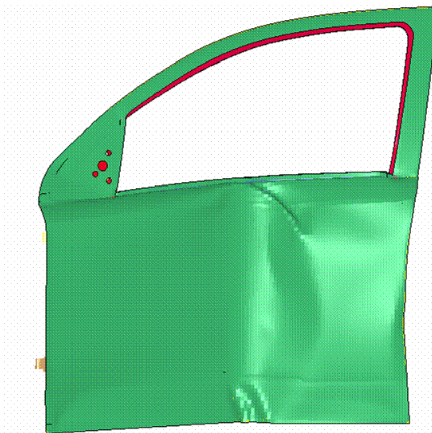
Figura 4.19 – Conjunto de porta atual após simulação de intrusão lateral.
