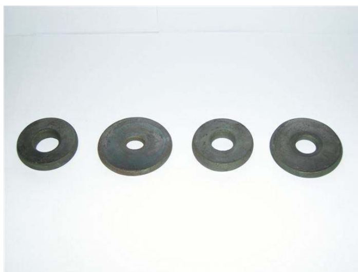
Figura 19: Amostras de anéis ensaiadas no LdTM da UFRG prensados.
