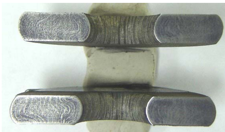
Figura 32: Corte da amostra 17 mostrando fibramento e a superfície neutra.
