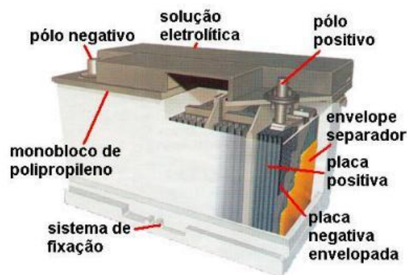
Figura 29 - Bateria Desmembrada
