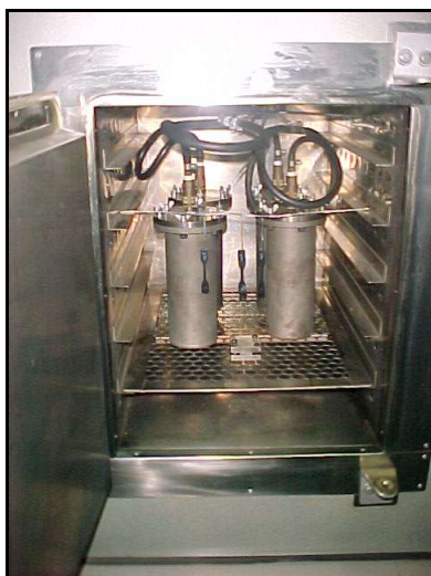
Figura 23 – Dispositivos e corpos-de-prova no interior da estufa. Três diferentes meios de teste.
