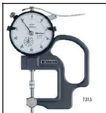
Figura 19 – Medidor de espessura marca Mitutoyo.
