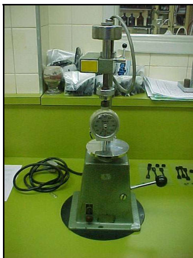
Figura 20 – Durômetro Shore A, montado em suporte para leitura.
