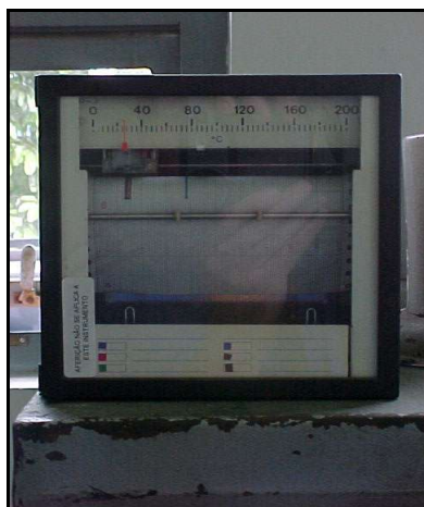
Figura 16 - Registrador de temperatura utilizado, marca Arucomp; escala de 0 a 350 °C; um canal por estufa.
