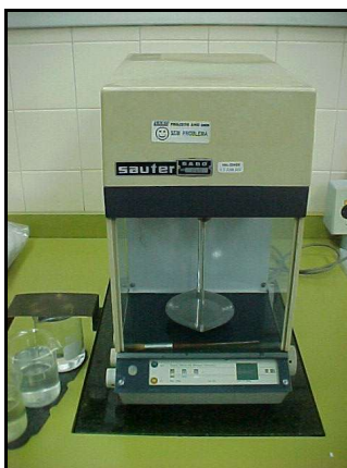
Figura 21 – Balança utilizada para avaliação da densidade e volume dos corpos-de-prova.
