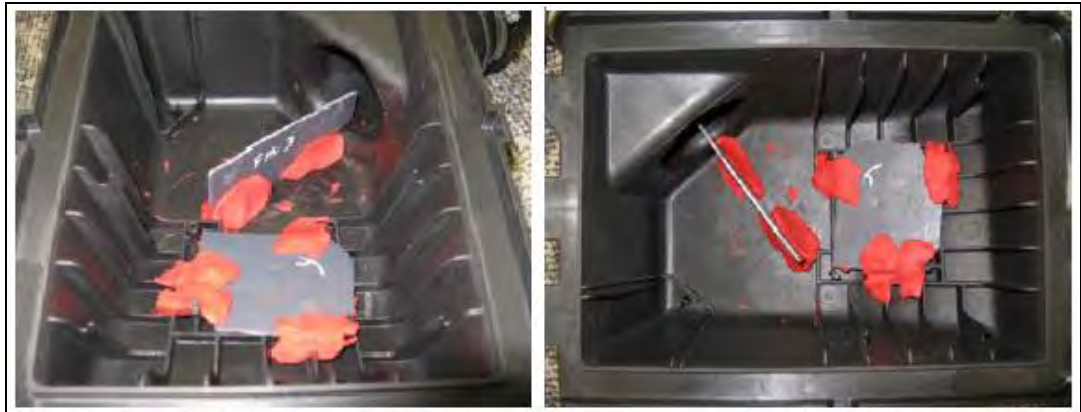
Figura 37 - Exemplo de modificações realizadas para testes em bancada. Imagens cedidas gentilmente pela empresa Mahle do Brasil LTDA.
