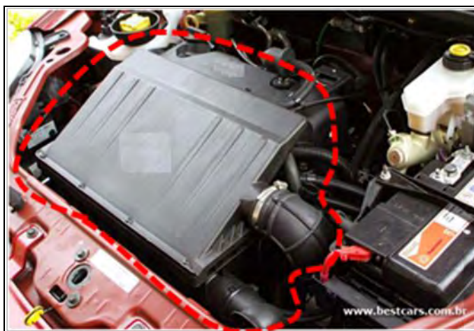
Figura 1 - Sistema de Admissão Integrado ao Motor Fonte: Ref. [25]
