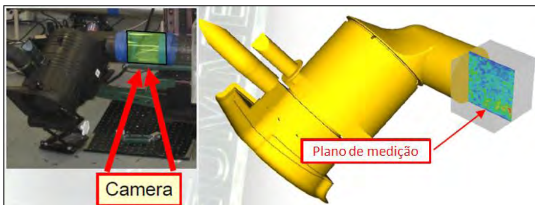
Figura 42 - Posicionamento das câmeras para medição SPIV na direção do fluxo de ar Imagem cedida gentilmente pela empresa Mann+Hummel.
