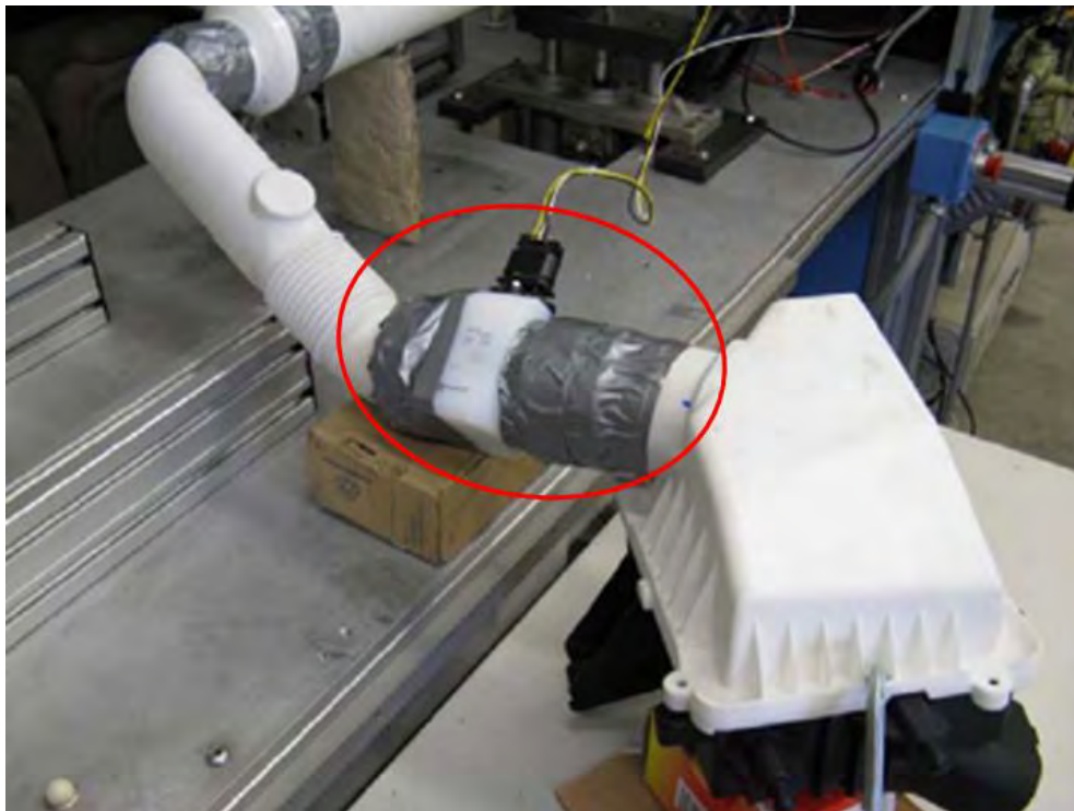
Figura 39 – Detalhe do dispositivo para permitir movimentos de translação e rotação. Imagem cedida gentilmente pela empresa Mahle do Brasil LTDA.
