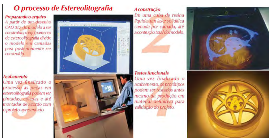
Figura 88 - Processo de fabricação de protótipos em estereolitografia Fonte: Ref. [24]
