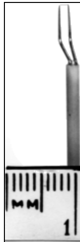
Figura 9 – Típico sensor cilíndrico ou de „fio quente” Fonte: Ref. [29]
