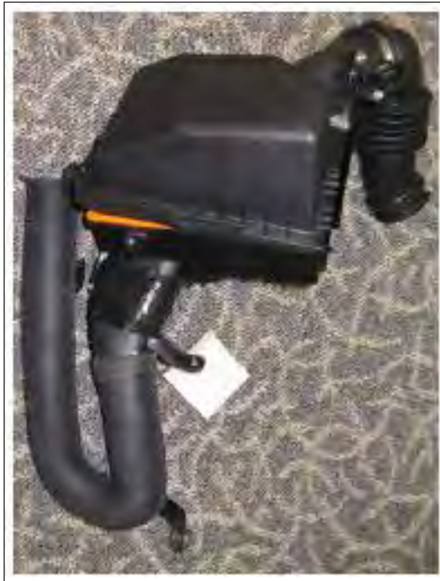
Figura 36 - Exemplo de um sistema de admissão de ar. Imagem cedida gentilmente pela empresa Mahle do Brasil LTDA.
