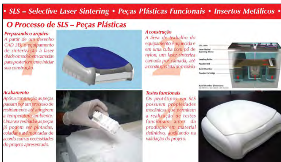
Figura 89 – Processo de fabricação de protótipos plásticos em SLS Fonte: Ref. [24]
