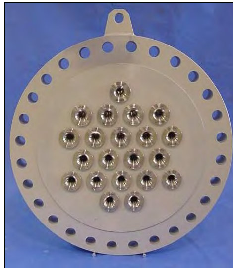
Figura 13 - Flange com bocais sônicos usinados Fonte: Ref. [15]
