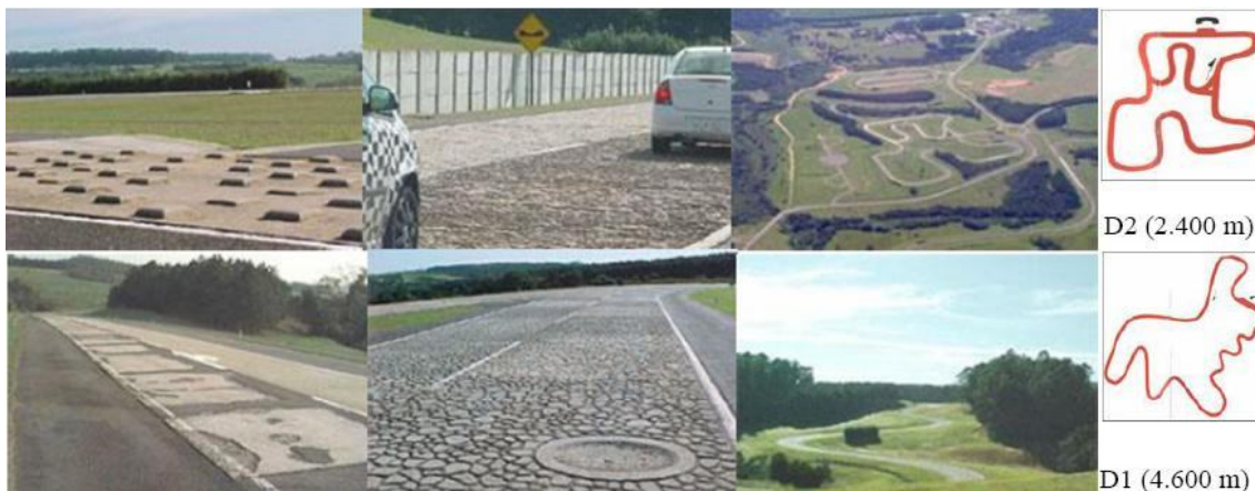
Figura 4.6 – Condições dos testes de durabilidade G4 no Campo de Provas Cruz Alta.
