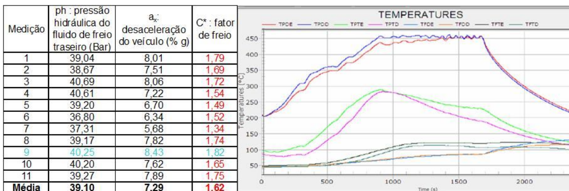
Figura 5.14 – Fator de freio e temperatura das pastilhas, lonas e fluido de freio no teste de descida de serra lenta.
