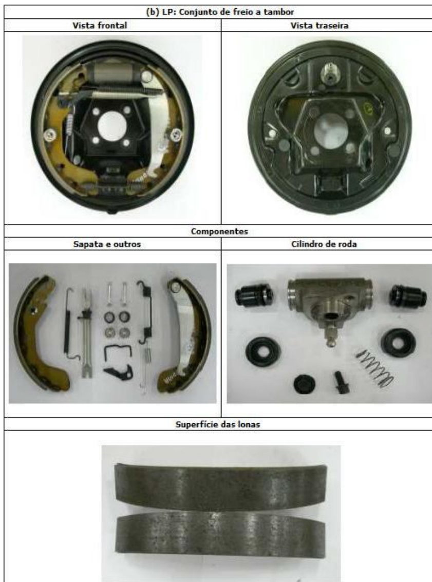
Figura 5.12 – Estado dos freios a tambor e seus componentes após teste estrutural, freio novo.
