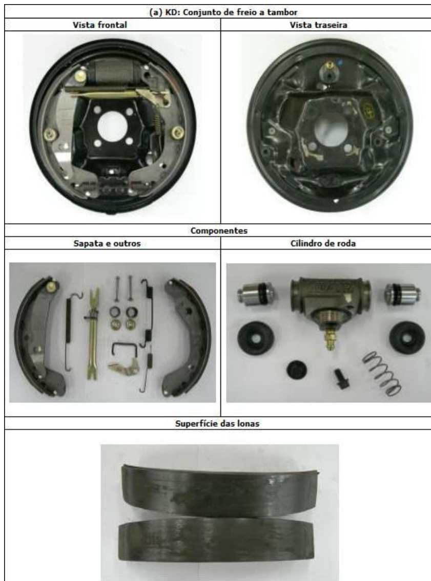
Figura 5.11 – Estado dos freios a tambor e seus componentes após teste estrutural, freio atual.
