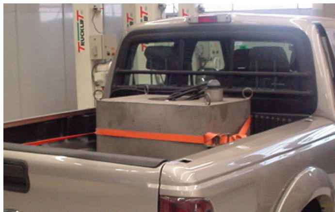
Figura 24. Detalhe de instalação do tanque sobressalente no veículo.
