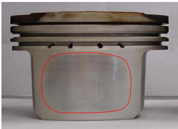
Figura 11. Detalhe da saia de um pistão após a utilização – Em destaque região onde ocorreu desgaste Fonte: Elaborado pelo autor
