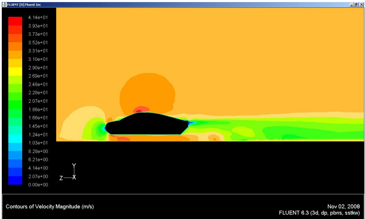
Figura 5.19: Diagrama de velocidade no plano vertical longitudinal.
