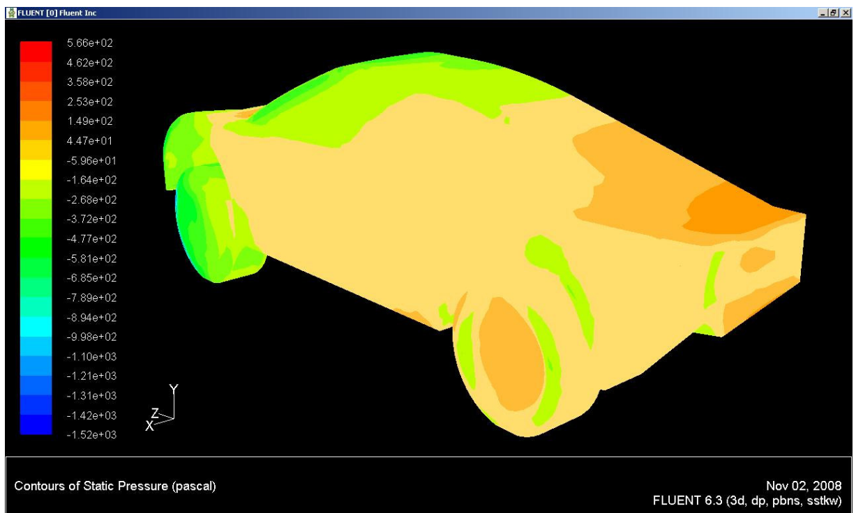
Figura 5.14: Diagrama de pressão na superfície do veículo, vista traseira superior.
