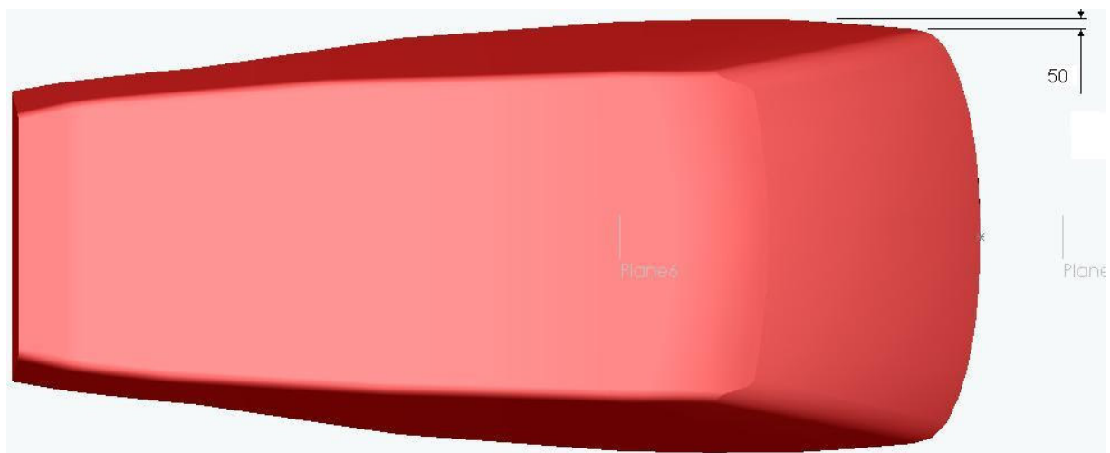
Figura 4.26: Coluna A e curvatura do plano lateral do teto na segunda versão.
