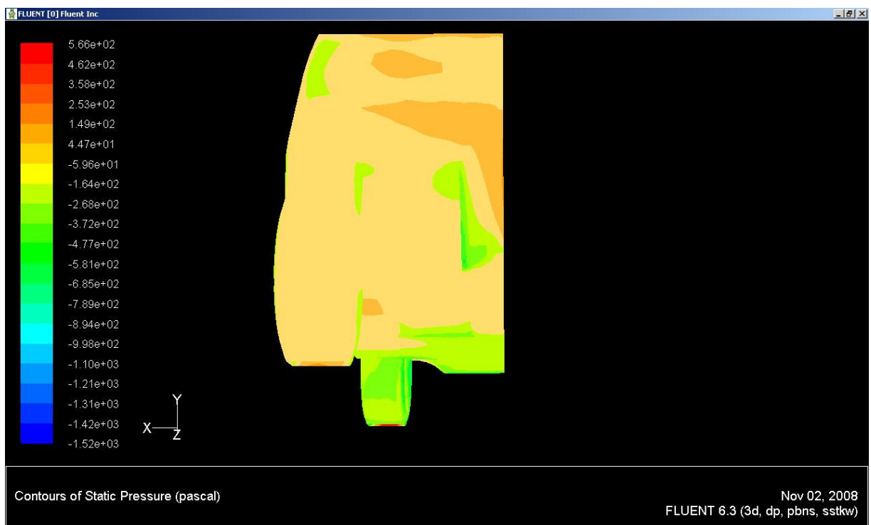
Figura 5.16: Diagrama de pressão na superfície do veículo, vista traseira inferior.
