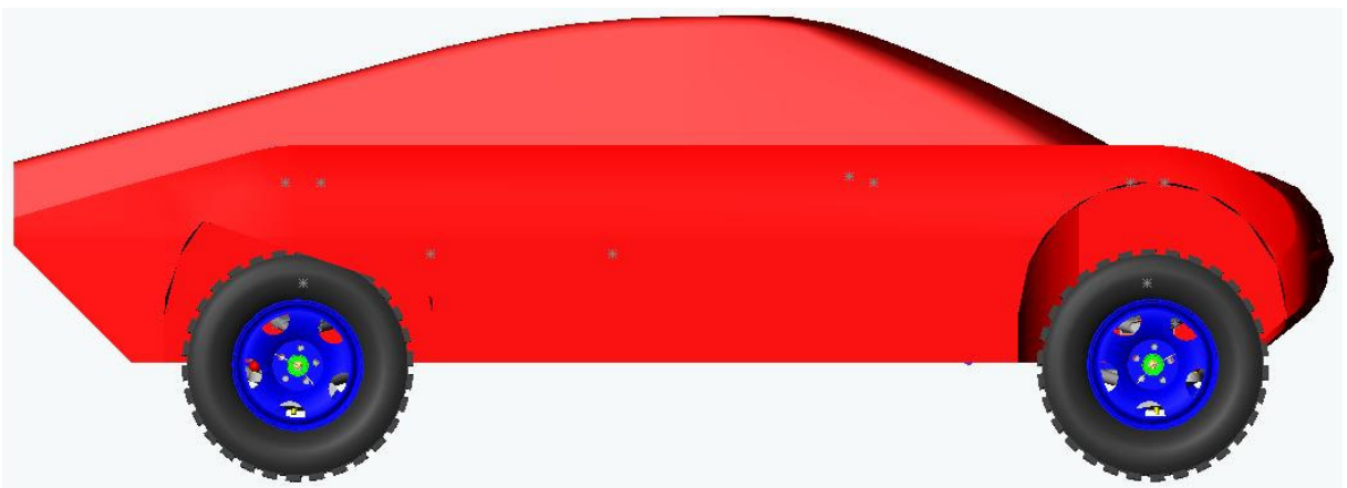
Figura 4.37: Inclinação da traseira do corpo em 15 graus.
