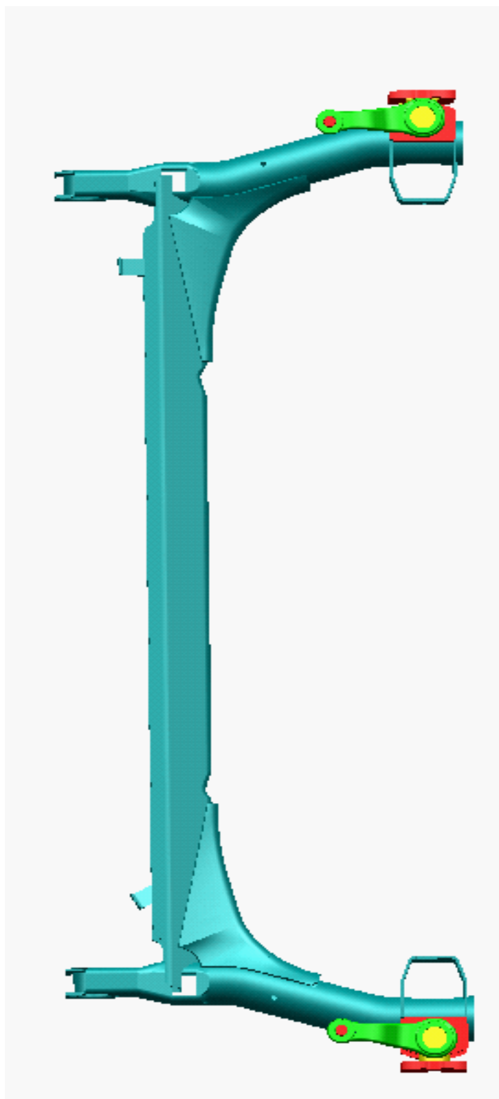
Desenho 3.7 – Vista inferior (por baixo) da manga soldada no eixo
